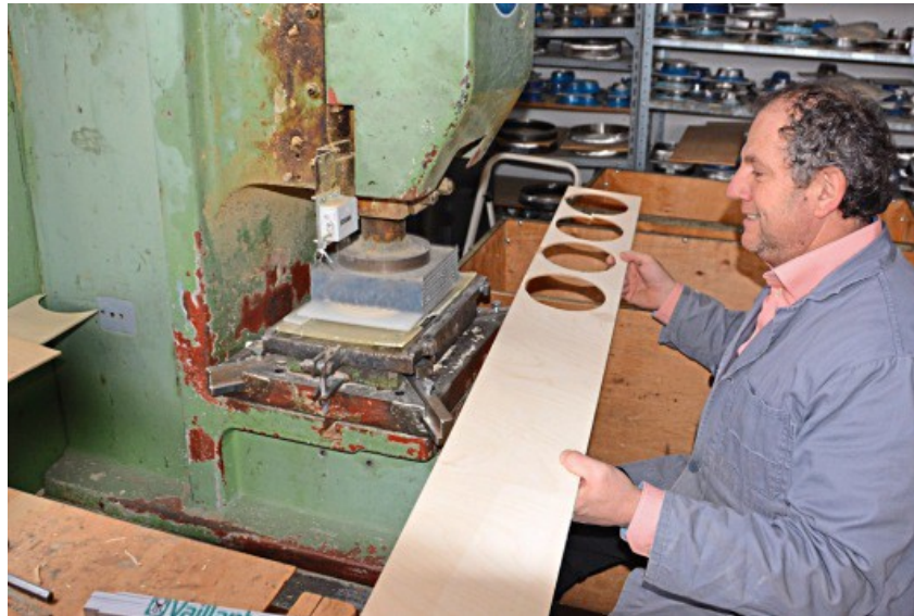
Franz Pillmeier an der Stanzmaschine, mit der vor allem Birkensperholz in unterschiedlichen Formen und Größen ausgestanzt wird. Statt aus Russland bezieht er jetzt Birke aus Skandinavien.
