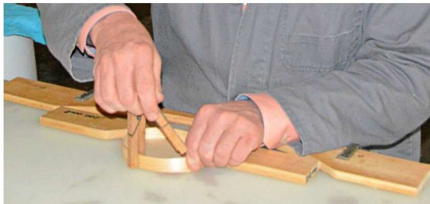
In die gewünschte Form werden die Späne eingepasst, an den Enden geklebt und schließlich mit Wäscheklammern fixiert.
