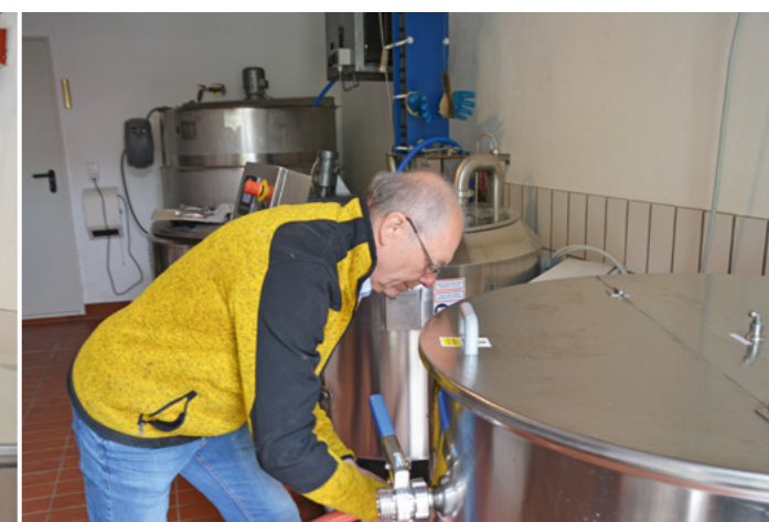
Anschließen des Schlauches, um den Sud von einem zum anderen Bottich zu pumpen.
