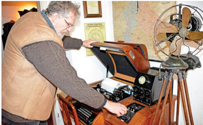
Peter Kahlich zeigt am Fernschreiber T 37 – Siemens baute ihn 1933 bis 1960 – wie man eine Nachricht rausgeschickt hat. Fotos: Markus Bauer
