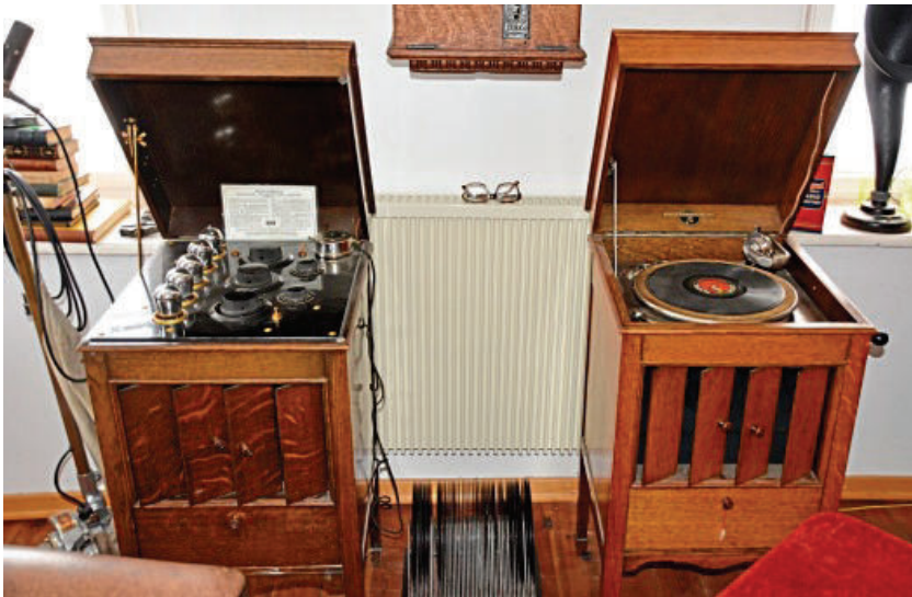
Synergieeffekte: Das gleiche Gehäuse fungiert als Hülle für ein Grammophon und für das damals neu aufkommende Radio.
