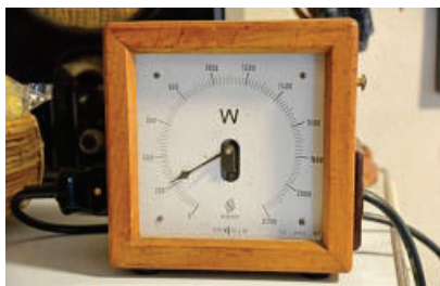
Natürlich verwendet Peter Kahlich auch alte Prüfgeräte – wie hier eines zur Messung des Stromverbrauchs, das um 1950 verbreitet war.
