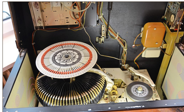
Ein Blick in die Mechanik der Atlanta. Links das Karussell, in dem 80 Singles Platz haben. Rechts der Plattenteller, auf dem die gewählte Scheibe aufgelegt wird.
